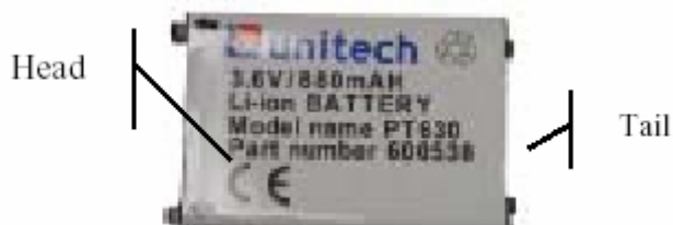
図 1-10 PT630 Li-ion バッテリ(パーツ番号: 600538)
