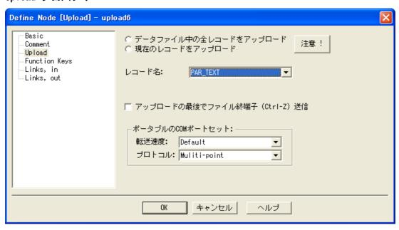
アップロードノードの機能は、マルチポイントプロトコル でポータブルターミナルからホストへデータを転送することです。アップロードノードの実行で、送るために定義されたすべてのデータは連続的にデータをポーリングしているホストアプリケーションに即座に送られます。
