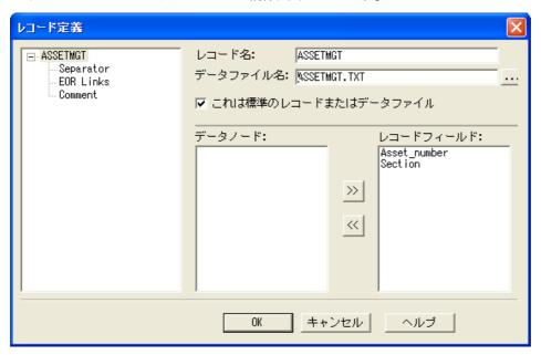
レコードの属性を書くフィールドは、収集ノードです。<u>収集ノードを定義して、</u>そしてレコードフィールドのチェックボックスを選択した場合、このノードは自動的にフィールドになります。標準では、JobGen Plus はすべての定義された収集ノードをレコードのフィールドとしてセットし、そしてレコード中のフィールドの順序はノードの定義の時刻 - 最初に定義された収集ノードが最初のフィールド、次の収集ノードが二番目、等々 - で決定されます。フィールド分離子はフィールドの分離のために使用され、そしてレコード終端子はレコードを分離するために使用されます。プリアンブルとポストアンブルは文字列です。プリアンブルはレコードのデータの前にセットされ、ポストアンブルはレコードのデータの後にセットされます。
