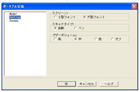
スクリーン ディスプレィのフォントサイズを定義。日本語を表示させる 場合は大型フォントを選択して下さい。
