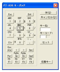
キーマップを変更したいキーボタンをクリックします。キーの名前が右側のキーボックスに表示され、そして ASCII コードが印刷可能な文字でキー名の下の、二つのキーコードボックスに表示されます。
