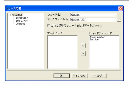
レコード定義ダイアローグボックスには、二つのスクロール・ウインドウ: **データノード**: 、 左のウインドウと**レコードフィールド**: 、右のウインドウがあります。ジョブで作成されたすべての収集ノードは、**データノード**: ウインドウにリストされ、そしてレコード中のすべてのフィールドは、**レコードフィールド**: ウインドウにリストされます。これらの二つのウインドウ間には**追加(>>)** と 削除(<<) ボタンがあります。
