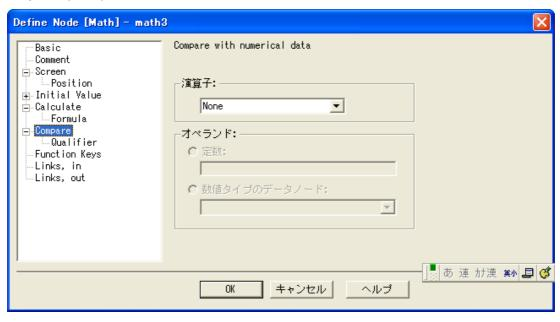
比較の演算子とオペランドを定義します。比較の結果はリンクの成功または失敗状態として使 用することができます。
