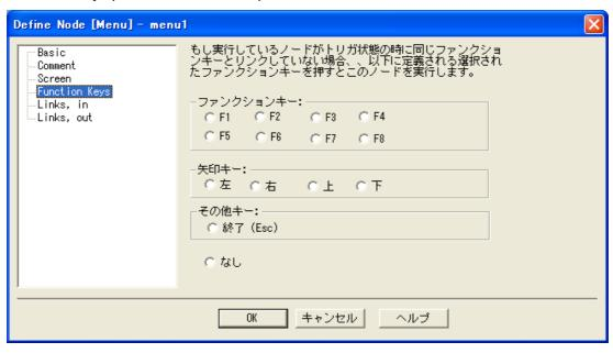
ジョブを実行中に、このノードで定義したファンクションキーを押すことによりこのノードの 実行フローを指示します。しかし、現在のノードがこのファンクションキーのキー入力状態に リンクされている場合、このリンクはその相手先ノードを実行するために高い優先度を持ちま す。
