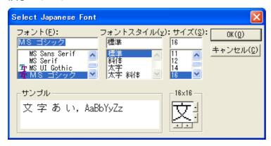
JobGen Plus はWindows 日本語版のフォントライブラリから漢字のビットマップを探し、コードとビットマップの両方を含むファイルを作成します。このファイルはジョブの実行形式と一緒にポータブルターミナルにダウンロードされます。フォント・タイプ、スタイル、そしてサイズを選択することができます。ポータブルターミナルに表示される漢字のビットマップサイズは 16 x 16 ピクセルです。ビットマップの文字位置のレイアウトを調整することもできます。
