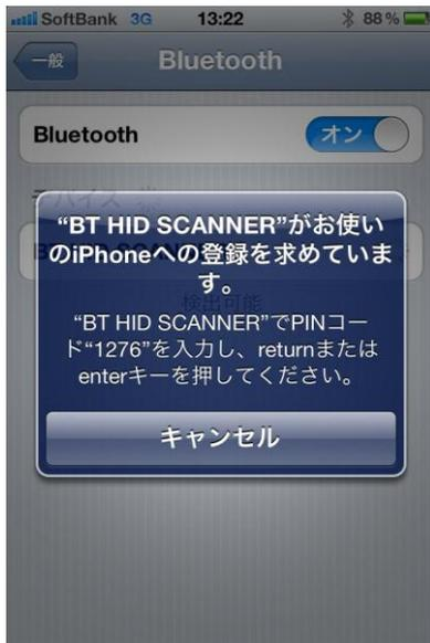
1.8. MS840BT で以下のバーコードを使用して PIN コードを入力してください。
